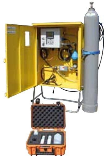
4 m<sup>3</sup>, mit BigBag. Vorne kann eine Begasungsanlage angeflanscht werden oder sie wird im optionalen Begasungsschrank untergebracht
