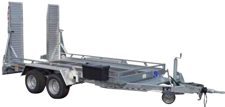
zum Beispiel der **Tandem-Tieflader** GTA mit verzinktem Fahrgestell. Dank Tandem-Achsen ruhiges und stabiles Fahrverhalten.
