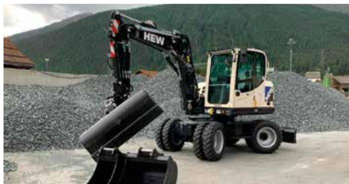
YANMAR B75W-5 für HEW AG, Felsberg: mit Allrad-Lenkung, 30km/h, Gelenkausleger, Powertilt mit hydr. Schnellwechsler und Heckschild. Komfortausführung, Klimaanlage, el. Betankungspumpe, Zentralschmieranlage und vieles mehr.
