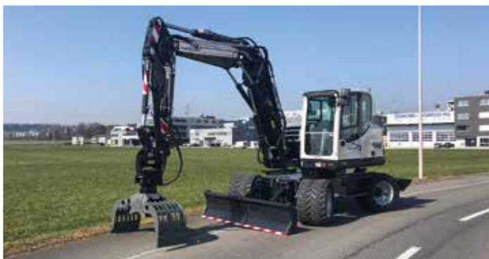
YANMAR B110W für Paroli Bau, Luzern. Mit Allrad-Lenkung, 25km/h, Gelenkausleger, Powertilt mit hydr. Schnellwechsler, Fronträumschild und Prätzen. Komfortausführung, Klimaanlage, el. Betankungspumpe, Zentralschmieranlage und Kinshofer Sortiergreifer D12H. Bestens geeignet für den Abbruch und die Sortierung von Baumaterial und Abfällen aller Art!
