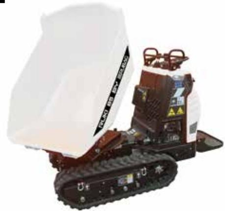
Dumpers sur chenilles (charge utile 500 à 1400 kg, avec benne frontale, trois côtés ou benne rotante)
