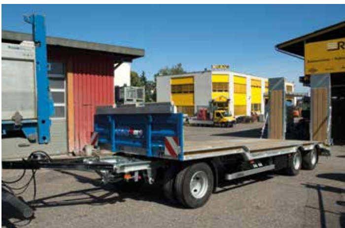
Série TUE pour le transport de machines de chantier + containers Remorque à 3 essieux DBTAG , coudé
