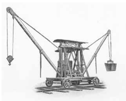
Double grue de potence automotrice
