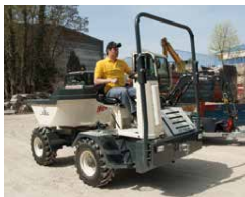
Véhicule spécial 4R1900RH avec siège rotatif
