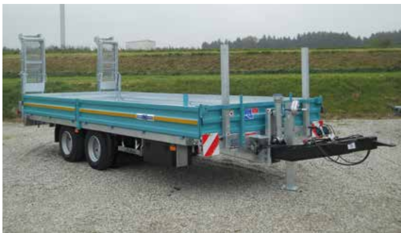
Transporteur de machines avec rampes pliantes et rétractables
