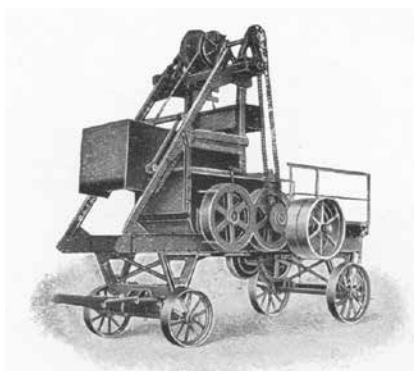
Bétonnière automotrice avec treuil
