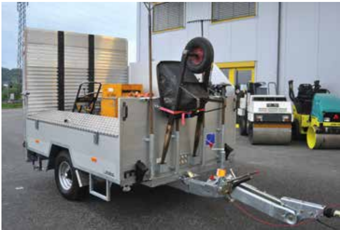
Remorque spéciale pour travaux de revêtement (Ville de Zurich)
