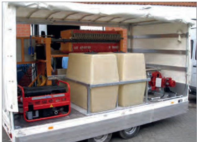
Von links: Stromerzeuger, Klarwassertanks, Schlamm-pumpe
