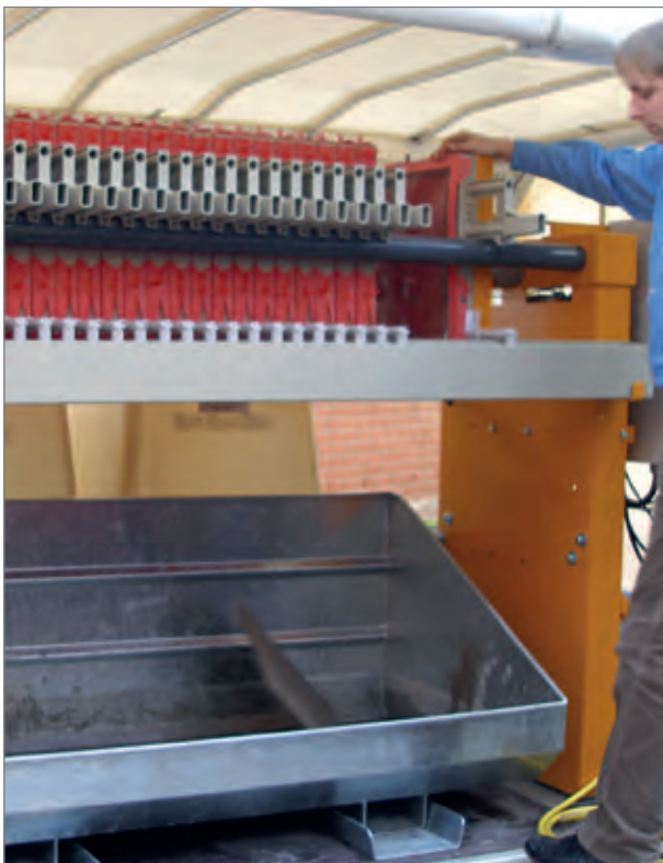
Zum Entleeren des Filters werden die Filterelemente auseinander gezogen.
