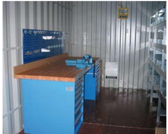
**Installations-Container** für ARGE Kraftwerk Limmern. Eingerichtet als mobile Werkstatt oder Lagerraum. Bei diesem Auftrag haben wir alle Container mit Licht, Heizung und Regalsystemen ausgestattet.
